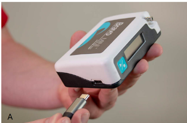
Figure 1 : Connecter le Bravo Mini à un PC
