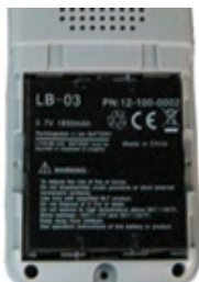
Figure 7-3 Installez la batterie
