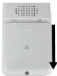
Figure 7-2 Poussez le couvercle vers le bas
