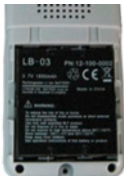
Abbildung 7-3 Einlegen der Batterie
